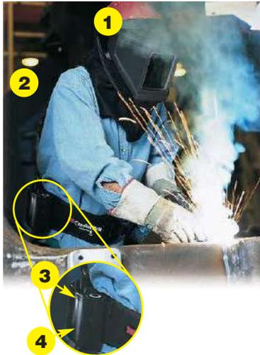
Les pièces faciales 3M<sup>MC</sup> de série L avec respirateur d'épuration d'air propulsé GVP offrent un ensemble avec casque dur, écrans pour soudage/meulage et respirateur intégrés. Créer un ensemble homologué par le NIOSH en choisissant parmi les composants ci-dessous.
