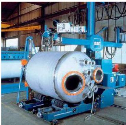
Le gain de productivité principal réside dans le fait que le procédé permet de souder des assemblages bout à bout à bords droits (dans une certaine gamme d'épaisseurs) et qu'il n'est pas nécessaire d'effectuer plusieurs passes de remplissage. La nature automatique de ce procédé ainsi que la faible surépaisseur de soudure diminuent d'autant les opérations après soudage telles que le meulage.
