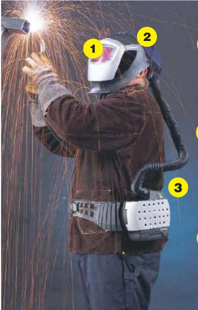
Les masques Speedglas<sup>MC</sup> 3M<sup>MC</sup> avec systèmes Adflo<sup>MC</sup> offrent tous les avantages des lentilles photosensibles Speedglas<sup>MC</sup> avec respirateur d'épuration d'air propulsé intégré.
