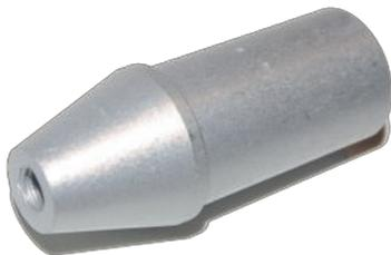
Embout aluminium 2017 T4 fileté M6 pour tube Zical 20 x 0,8 mm, permet de réaliser des commandes push-pull ultra légères associées à un embout à rotule ASKUBAL.
